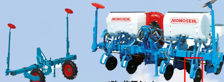
リジッドモノバー フレーム 全幅・移動幅 3.0m
